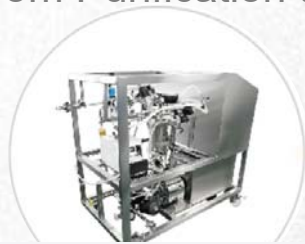
Ultrafiltration system 超滤系统
